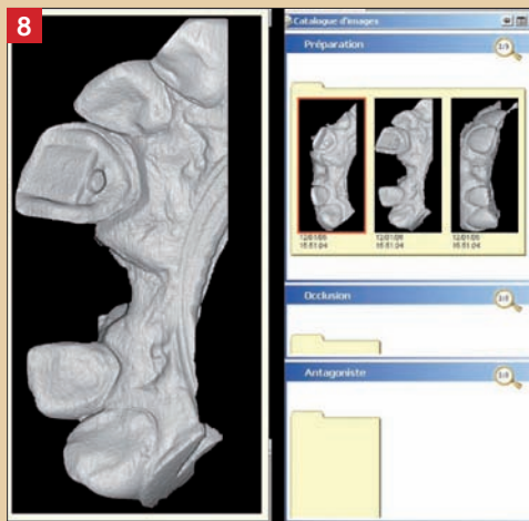
Fig. 7 à 11 : Vues de différentes étapes de laboratoire. Il a été choisi ici de réaliser cette restauration par CFAO indirecte. On visualise le maître modèle en plâtre qui va permettre le scannage par le Cerec In lab (Sirona). Nous obtenons après scannage une image virtuelle du modèle qui permet la CAO (Conception Assistée par Ordinateur). Une fois celle-ci réalisée, l'ordre est envoyé à la machine outil pour l'étape de FAO (Fabrication Assistée par Ordinateur).
