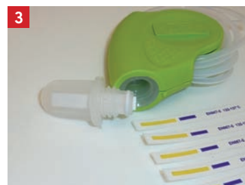
Fig. 1 : système pour le test Hélix composé d'un serpentín et des intégrateurs
