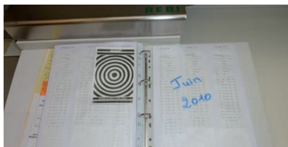
Résultat du test de Bowie-Dick archivé dans le cahier de traçabilité
