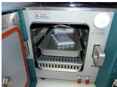
Le paquet test est disposé au centre de la cuve
