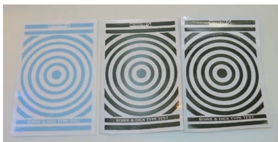
Changement de couleur de l'encre : état initial, mauvaise pénétration de vapeur (trace blanche centrale) et test validé (virage uniforme de la couleur).
