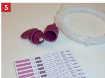
Fig. 1 : système pour le test Hélix composé d'un serpentín et des intégrateurs
