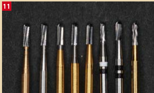
Fig. 11 : différentes fraises transmétalles.
