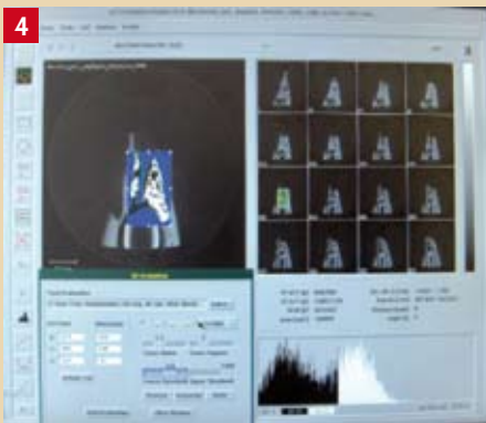
Fig. 4 : Reconstruction tridimensionnelle de l'échantillon par le logiciel du microtomographe.
