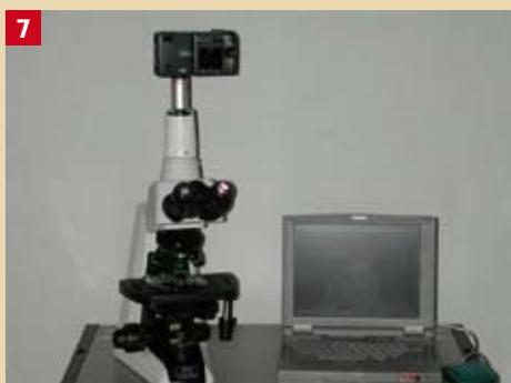
**Fig. 7 :** le microscope, sa caméra et son écran : le microscope est relié à une caméra numérique et un moniteur afin de pouvoir montrer au patient la nature infectieuse de sa maladie et de justifier les soins locaux de désinfection à réaliser par le patient ; s'il est couplé à un ordinateur il est alors possible d'archiver les données
